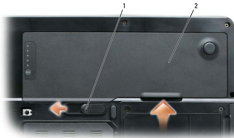
1 loquet de fermeture de la baie de batterie 2 batterie
